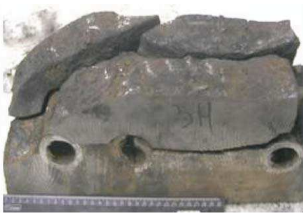
Рис. 3. Образование трещин в водоохлаждаемой трубке и теле чугунного холодильника
