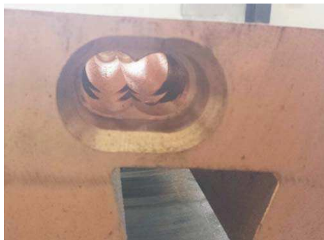
Рис. 4. Высверленный водоохлаждаемый канал медной холодильной плиты
