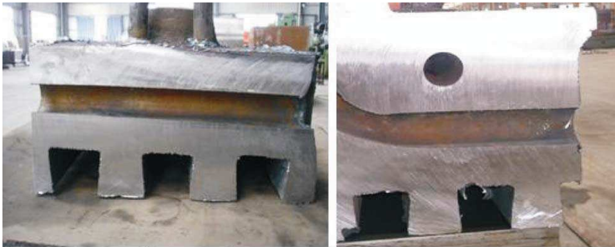
Рис. 6. Продольный разрез литого стального холодильника
