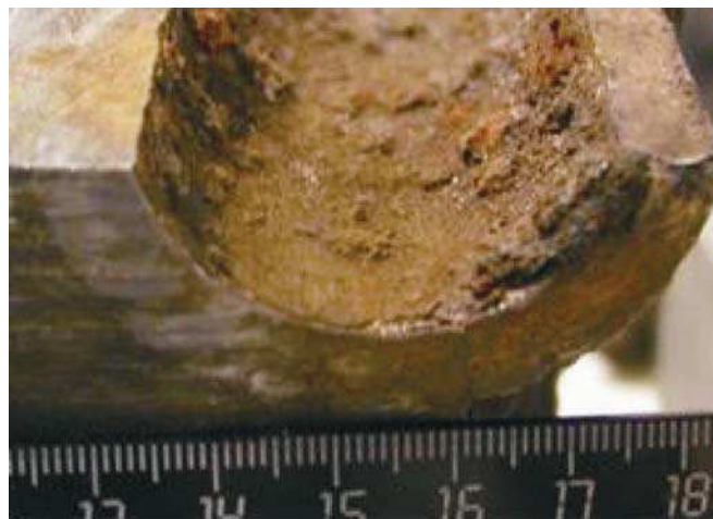
Рис. 2. Отложения \text{CaCO}_3 на внутренней поверхности трубки чугунной холодильной плиты при охлаждении технической водой
