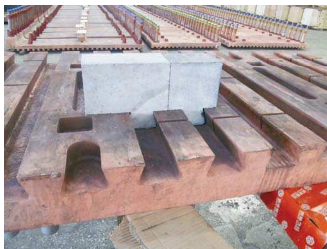
Рис. 5. Футеровка медных холодильных плит карбидокремниевым кирпичом
